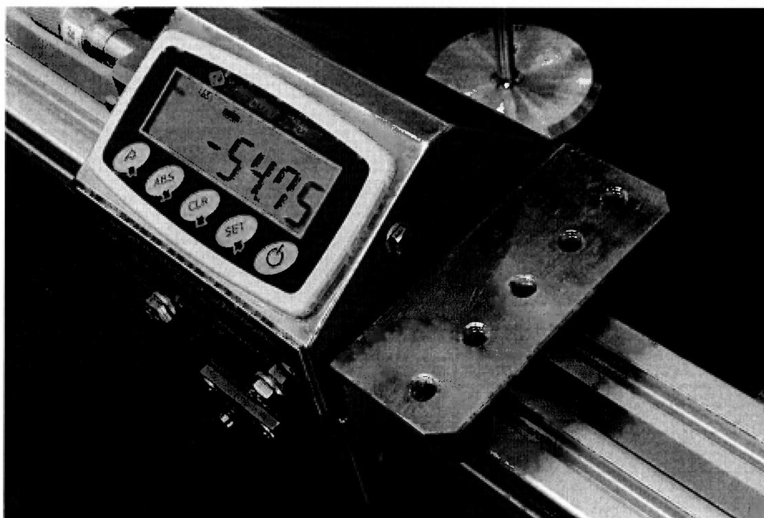
Рисунок 5 – Переходник для крепления стойки отражателя луча интерферометра
