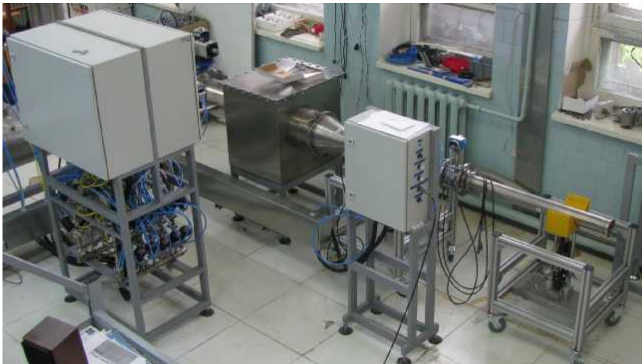
Рисунок 1 - Общий вид установки (малый сопловой блок, блок подключения поверяемого средства измерения)
