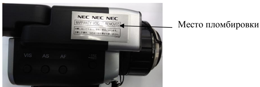
Рисунок 3 - Схема пломбировки от несанкционированного доступа
