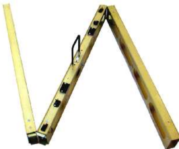
Рисунок 3 - Общий вид рейки дорожной универсальной РДУ-КОНДОР-Э
