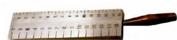
Рисунок 5 - Общий вид клинового промерника
