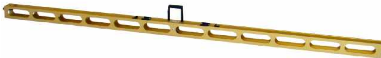
Рисунок 4 - Общий вид рейки дорожной универсальной РДУ-КОНДОР-Э-Н
