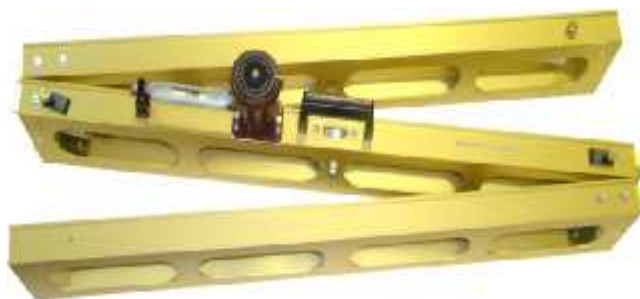
Рисунок 1 - Общий вид рейки дорожной универсальной РДУ-КОНДОР
