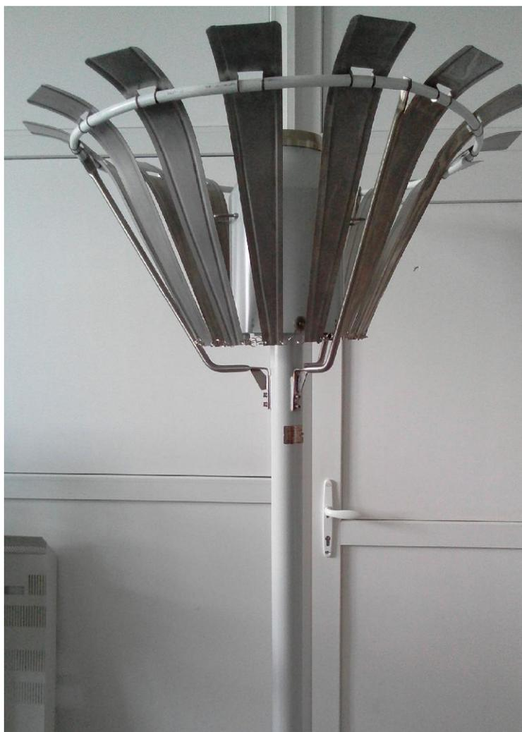
Рисунок 1 – Общий вид датчиков осадков «Пеленг СФ-11»
