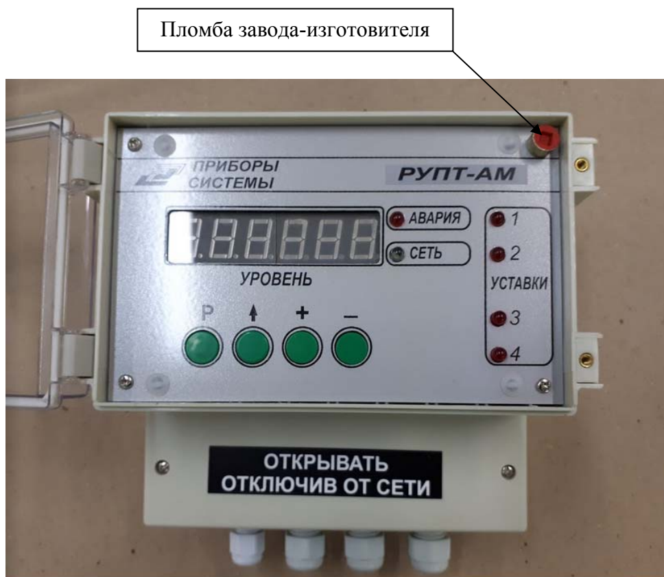
Рисунок 2 - Схема пломбировки от несанкционированного доступа, обозначение места установки пломбы завода-изготовителя
