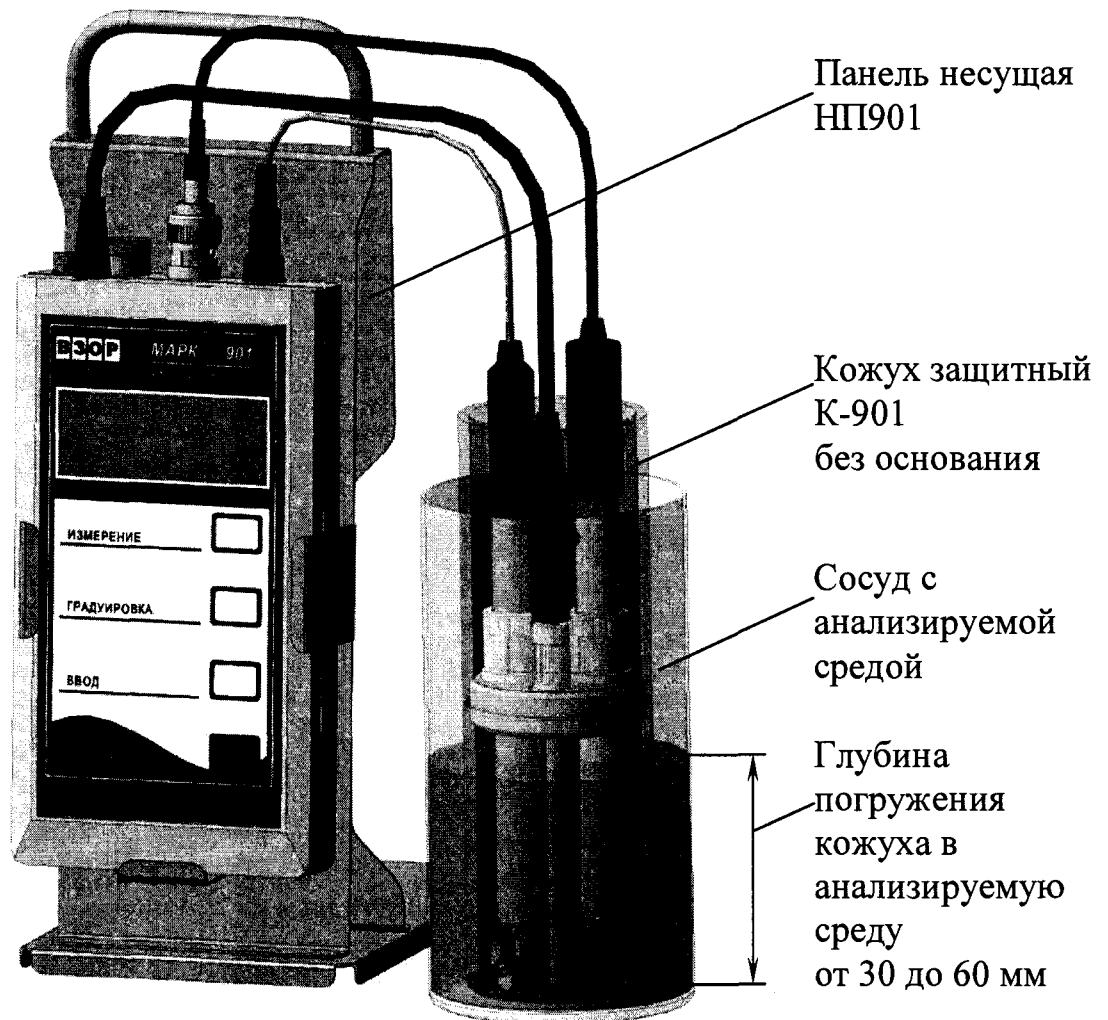
Рисунок 2.12 – Проведение измерений с использованием кожуха защитного К-901
