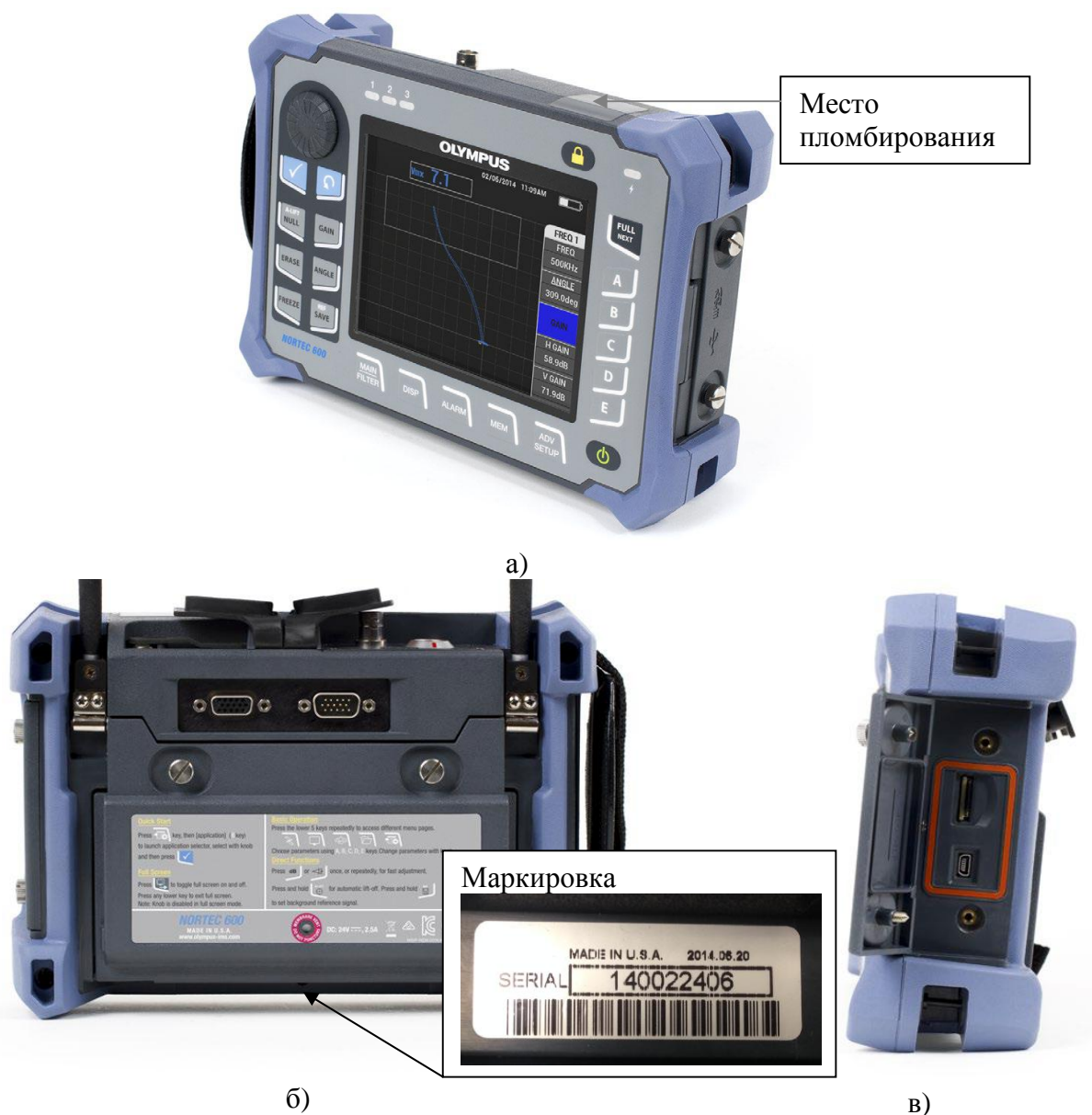
Рисунок 1 – Общий вид дефектоскопов с указанием схемы пломбирования и места нанесения маркировки а) вид спереди, б) вид сзади в) вид сбоку
