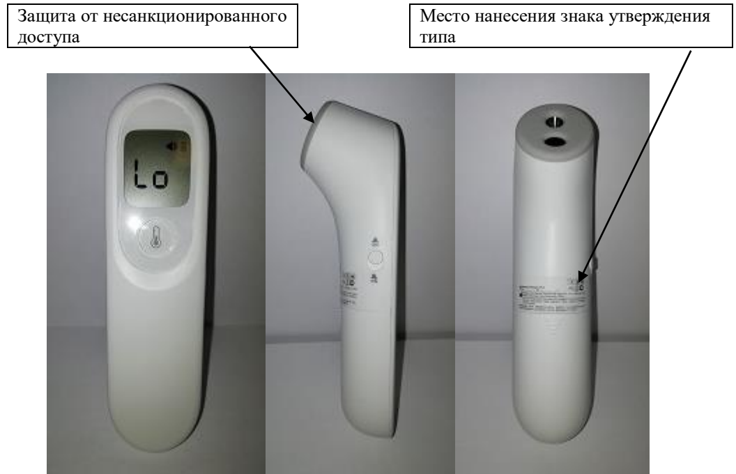
Рисунок 1 - Общий вид и схема пломбировки от несанкционированного доступа термометров «Armed»:YT-1
