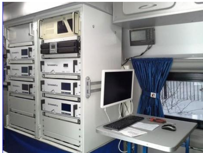
Рисунок 4 – Лаборатория экологического контроля передвижная «Алмаз-01» - лабораторный отсек
