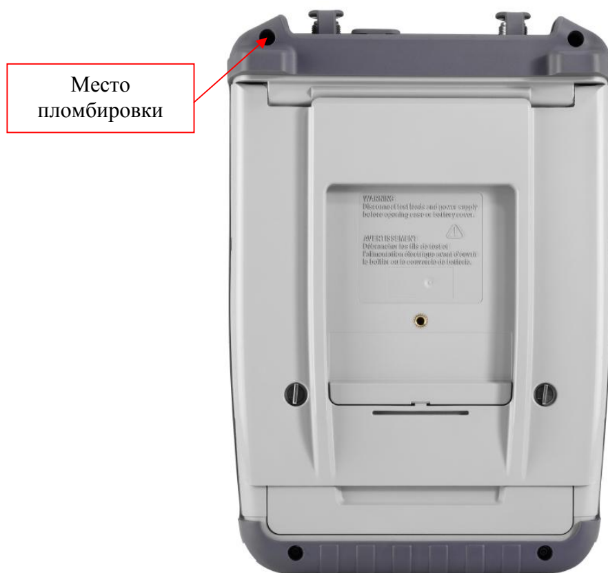
Рисунок 2 - Схема пломбировки анализаторов кабельных трактов и антенн ZPH от несанкционированного доступа
