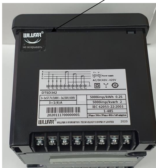
Рисунок 1 – Общий вид измерителей и схема пломбировки от несанкционированного доступа
