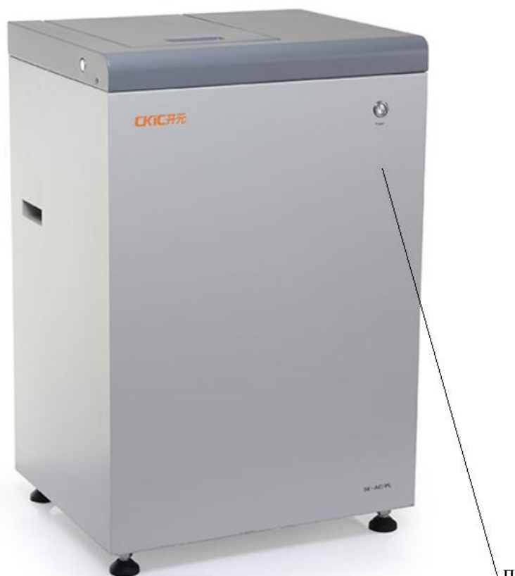
Рисунок 3 – Общий вид калориметра бомбового мод. AC/PL (позиция «п» обозначает место нанесения знака поверки)
