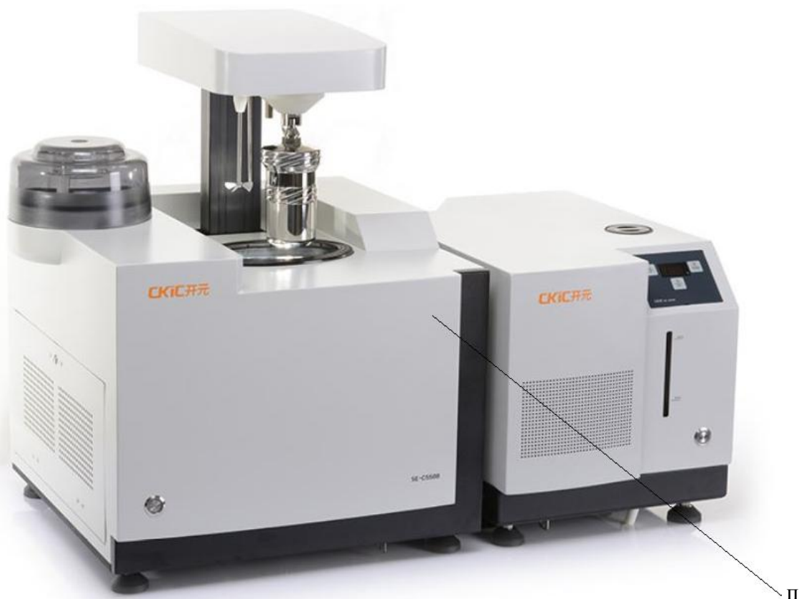
Рисунок 2 – Общий вид калориметра бомбового мод. 5E-C5508 (позиция «п» обозначает место нанесения знака поверки)
