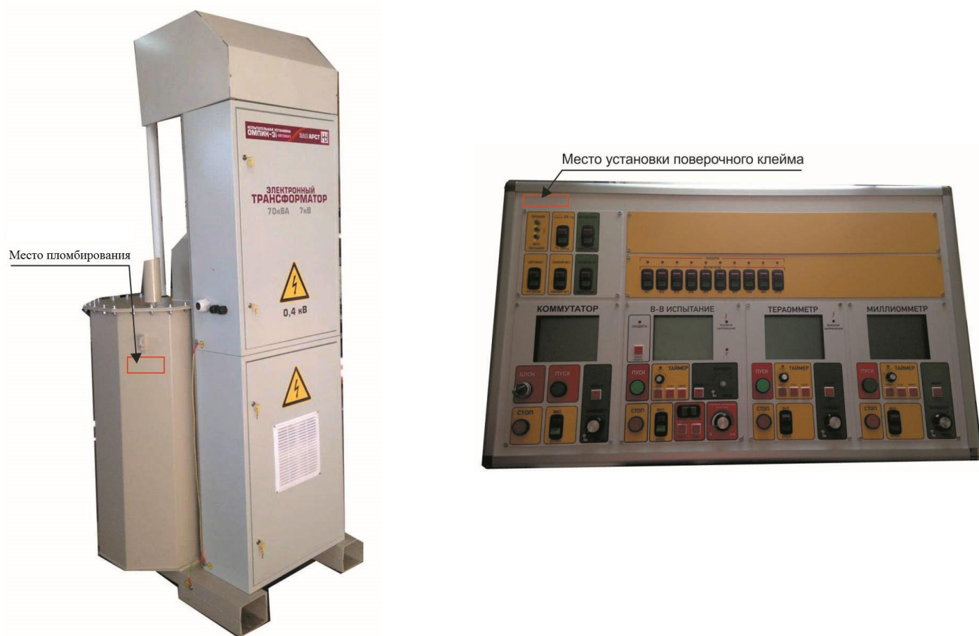
Рисунок 1 – Общий вид средства измерений и схема пломбировки
