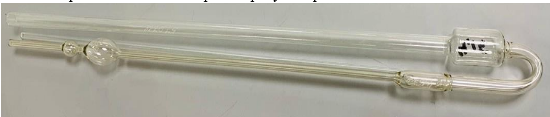
Рисунок 1 – Общий вид вискозиметра
