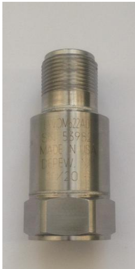
Рисунок 1 - Общий вид датчика виброскорости VO622A01
