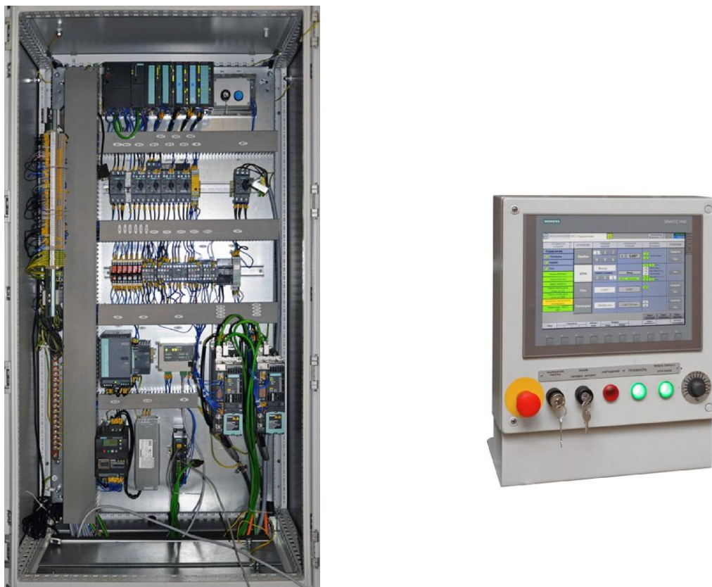
Рисунок 2 - Станция управления установкой и пульт ручного управления
