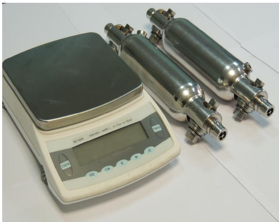
Рисунок 1 - Установка пикнометрическая (на рисунке представлены весы электронные лабораторные ВС, мод. ВС 5200, регистрационный номер 28377-04) (Конструкция, тип и форма весов может отличаться от приведенной на рисунке 1.)
