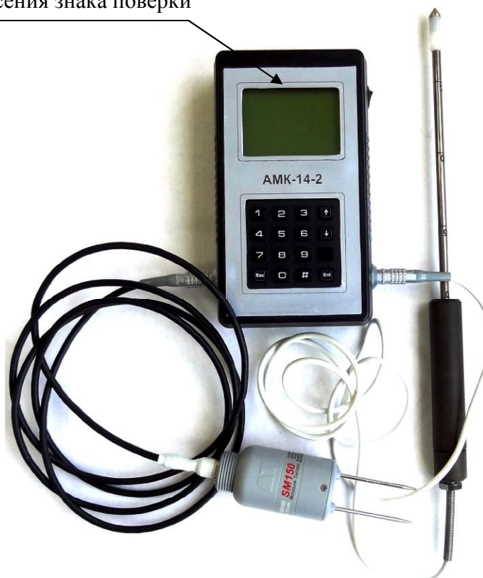
Рисунок 2 - Внешний вид комплекса агрометеорологического АМК-14-2 с датчиком-щупом температуры почвы и датчиком влажности почвы
