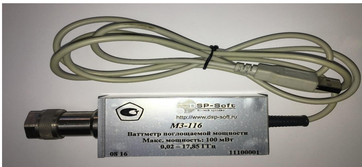
Рисунок 1 - Общий вид ваттметра поглощаемой мощности МЗ-116
