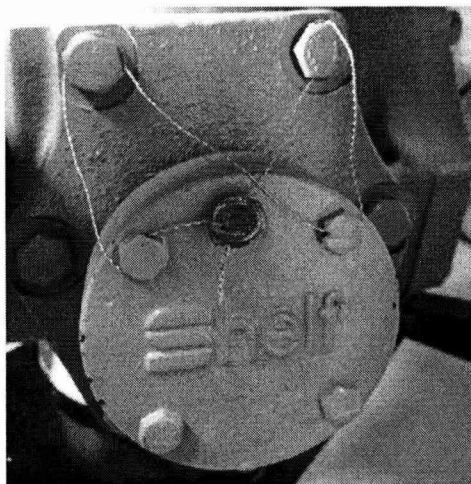
Рисунок 2 - Пломбировка измерителя объема типа Shelf
