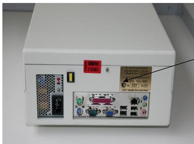
Рисунок 2 - Схема пломбировки от несанкционированного доступа
