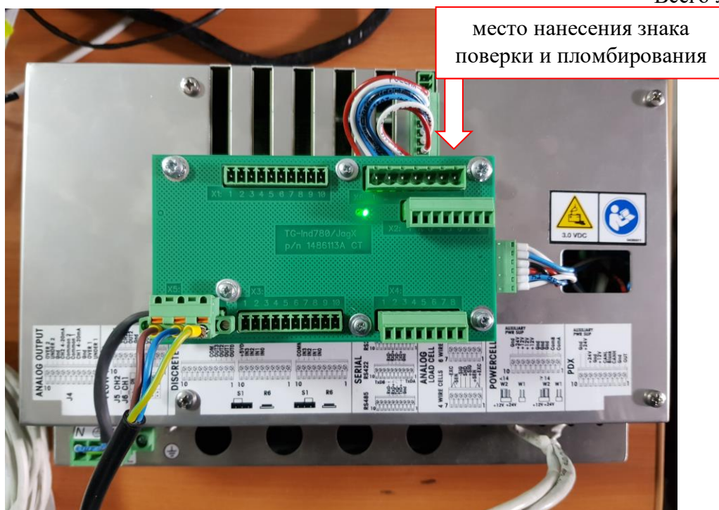
Рисунок 3 – Схема пломбирования от несанкционированного доступа и обозначение места нанесения знака поверки
