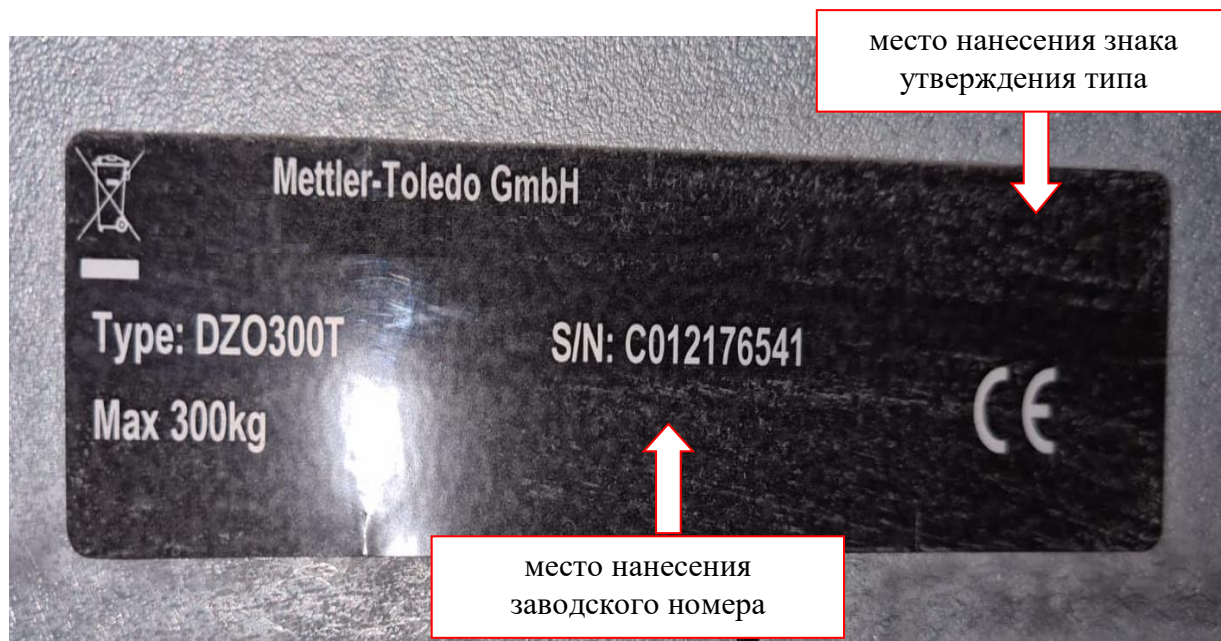
Рисунок 4 – Место нанесения заводского номера и знака утверждения типа
