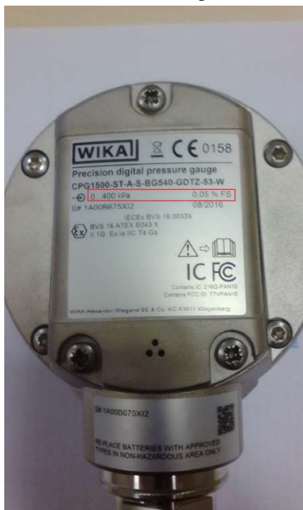
Рисунок 2 - Фотография калибратора давления CPG1500 (тыльная сторона)
