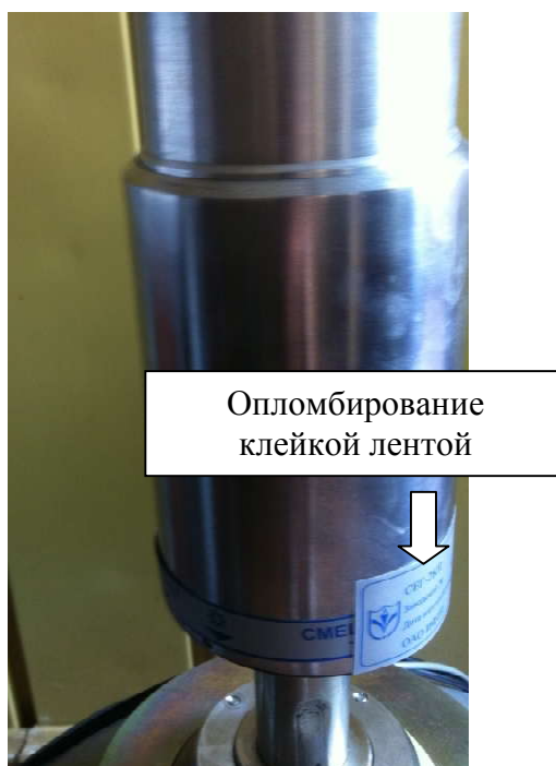
Рисунок 2 - Защита спектрометра энергии гамма-излучения СЕГ-1КП от несанкционированного доступа
