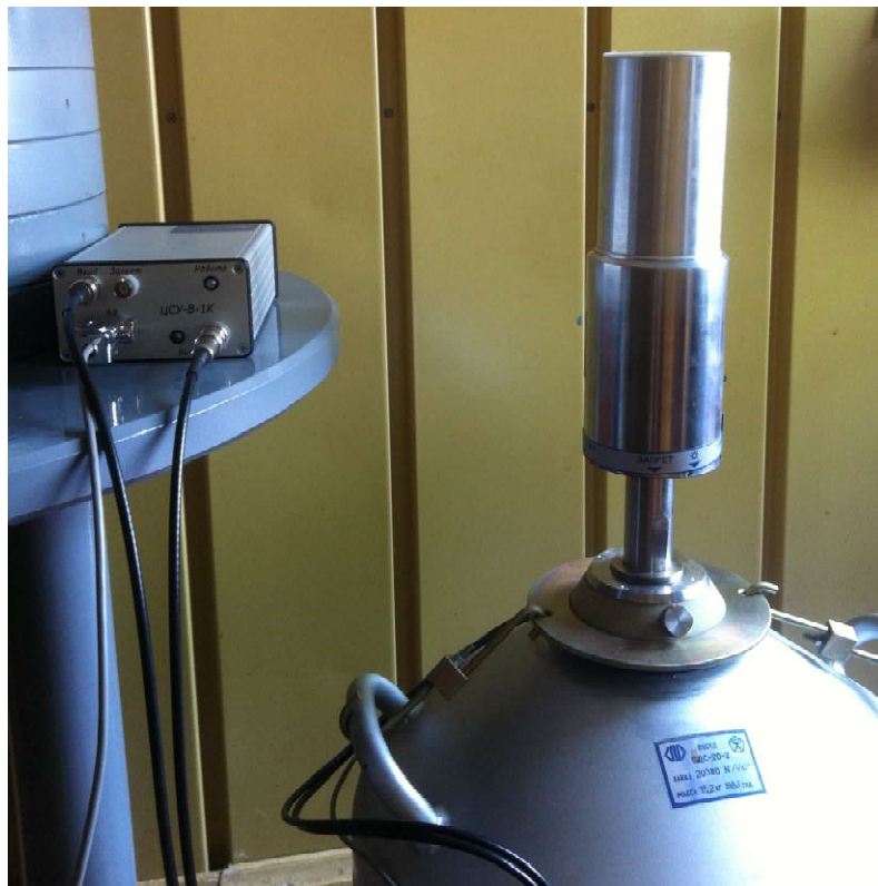
Рисунок 1 - Общий вид спектрометра энергии гамма-излучения СЕГ-1КП
