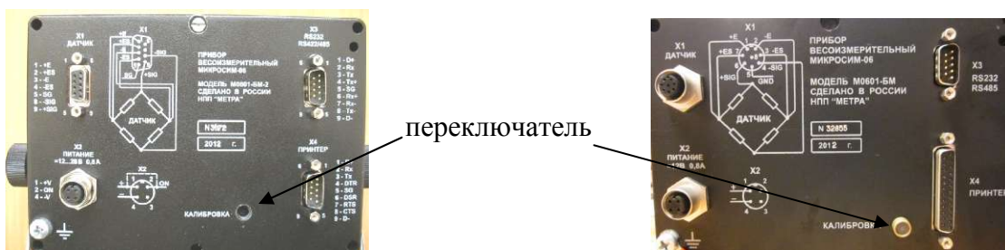
Рисунок 8 - Схема пломбировки весоизмерительного прибора Микросим 0601 от несанкционированного доступа
