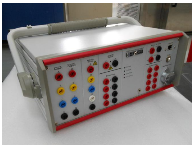
Рисунок 1 - Общий вид прибора проверки устройств релейной защиты PW666i
