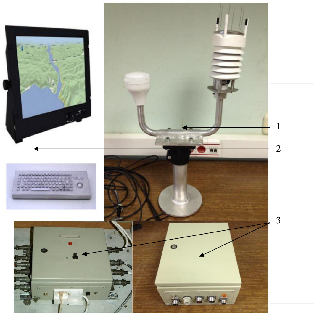
Рисунок 1 – Общий вид комплексов «Сюжет-КМ». 1 – модуль измерительный, 2 – модуль отображения и регистрации данных, 3 – модуль сбора и обработки данных.
