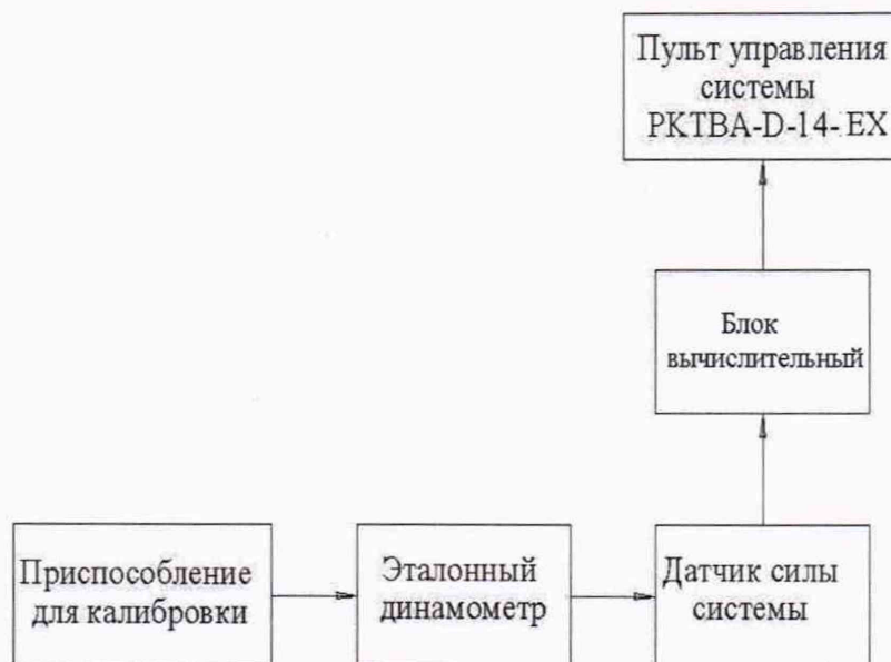
Рисунок 2 – Схема проверки каналов измерений силы растяжения
