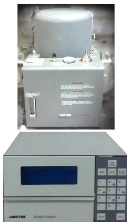
Рисунок 1 - Анализатор влажности газа Ametek 5000 с блоком управления
