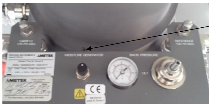
Рисунок 3 - Место пломбирования стопорного винта на корпусе анализаторов
