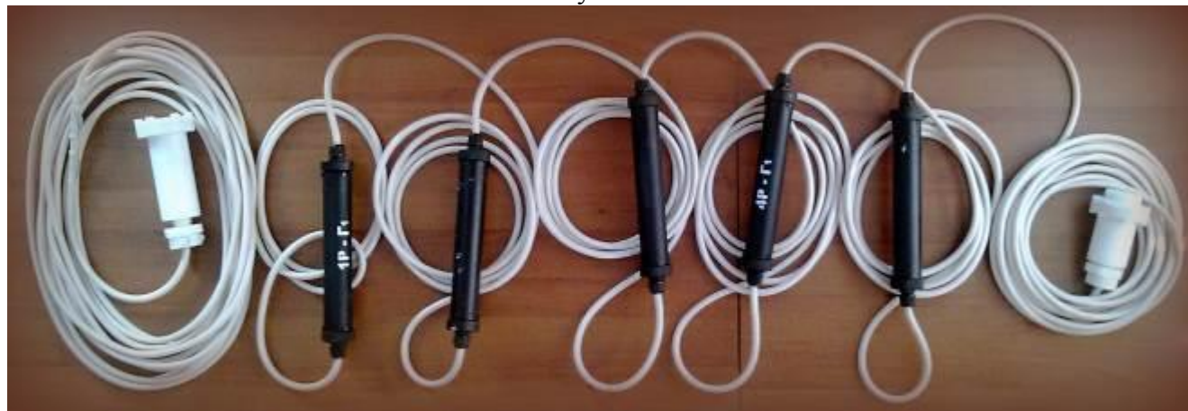
Подводная часть. Гирлянда рабочих электродов.
