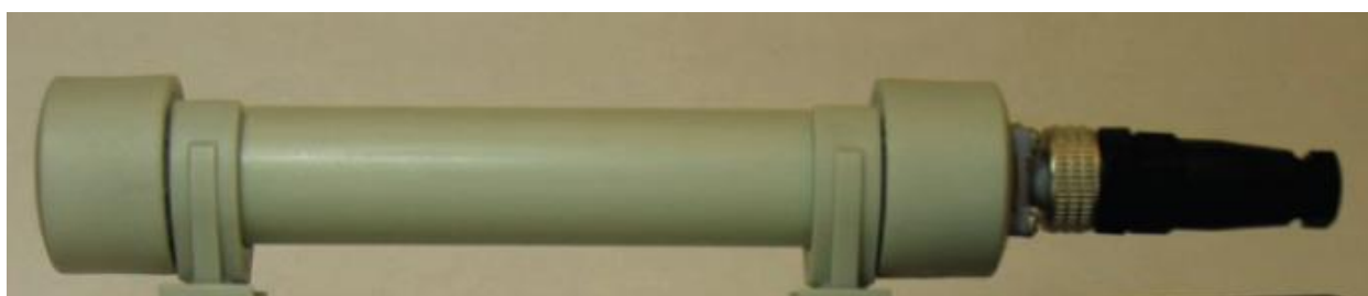
Рисунок 5 – Внешний вид антенны РБУ
