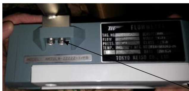
Рисунок 2 - Обозначение места пломбировки ротаметра М-901
