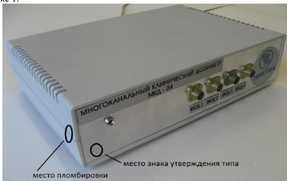
Рисунок 1 - Внешний вид блока регистрации и обработки информации дозиметров
