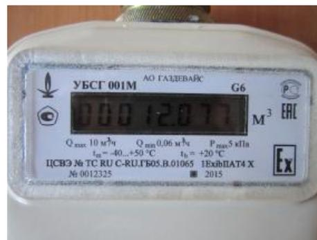
Рисунок 3 – Маркировочная табличка счетчика газа УБСГ
