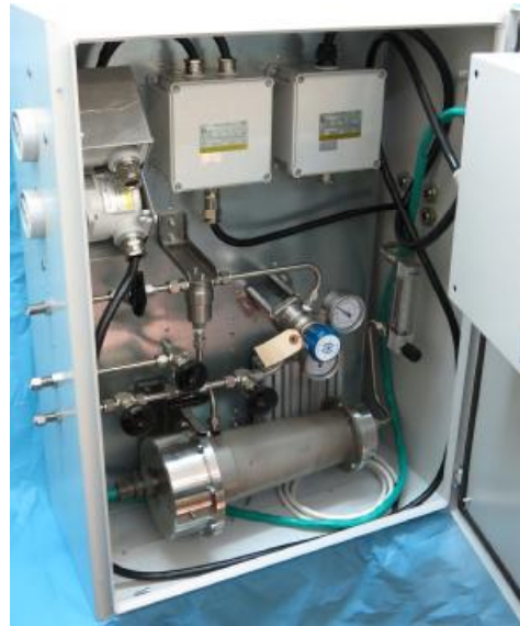
Рис.2 Внутреннее устройство гигрометров лазерных «ГЛ-02»
