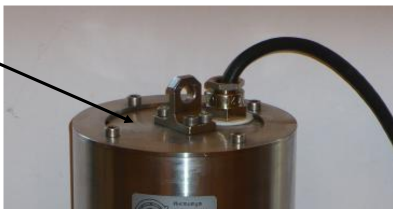
Рисунок 2 - Схема пломбировки от несанкционированного доступа
