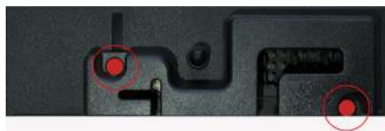
Рисунок 2 - Схема пломбировки от несанкционированного доступа и место нанесения знака утверждения типа
