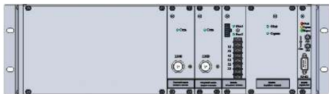
Рисунок 12 – Электронный блок резервированного блока питания повышенной надежности (вид сзади)
