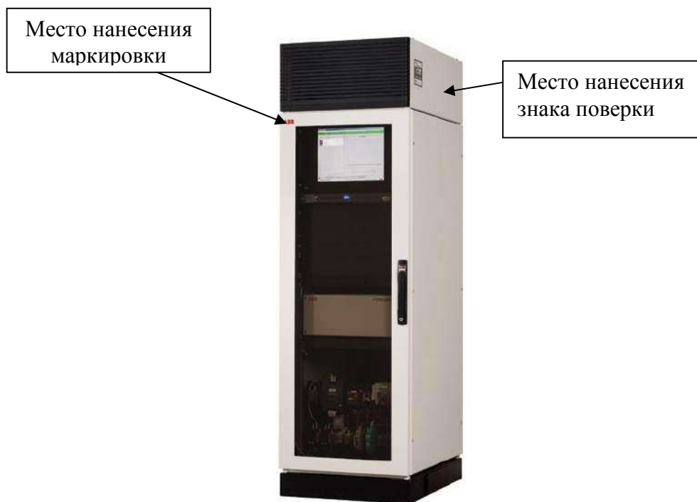
Рисунок 6 - Общий вид Фурье-спектрометров инфракрасных модели ФТРА2000-НР260 с указанием мест нанесения маркировки и знака поверки
