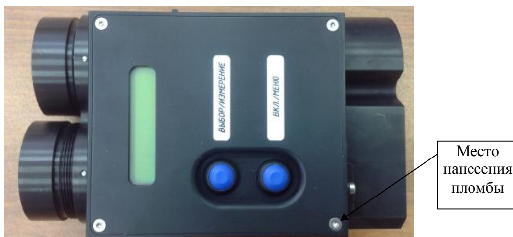
Рисунок 1 - Внешний вид модулей измерителя дальности и скорости лазерного ПСВ-1550 и схема пломбировки
