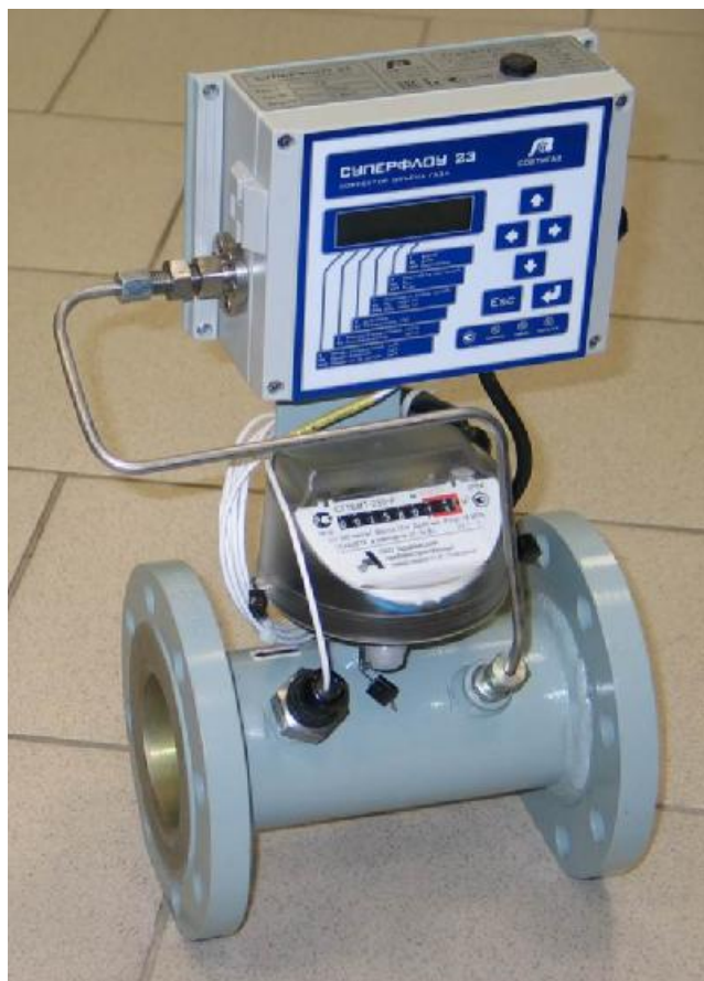
Фото 1 - Общий вид измерительного «Суперфлоу 23СГ»
