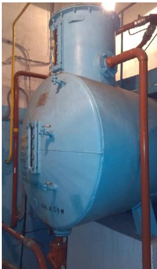
Фото 1 - Общий вид мерника металлического технического 1 класса МТ-2500
