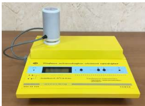
Рисунок 1 - Измеритель низкотемпературных показателей нефтепродуктов ИНПН SX-800
