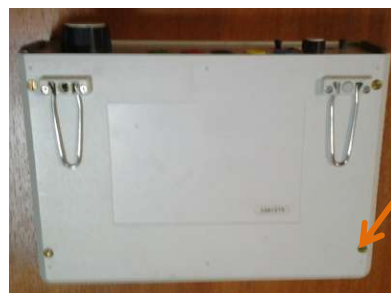
Рисунок 2- Схема пломбировки анализатора
