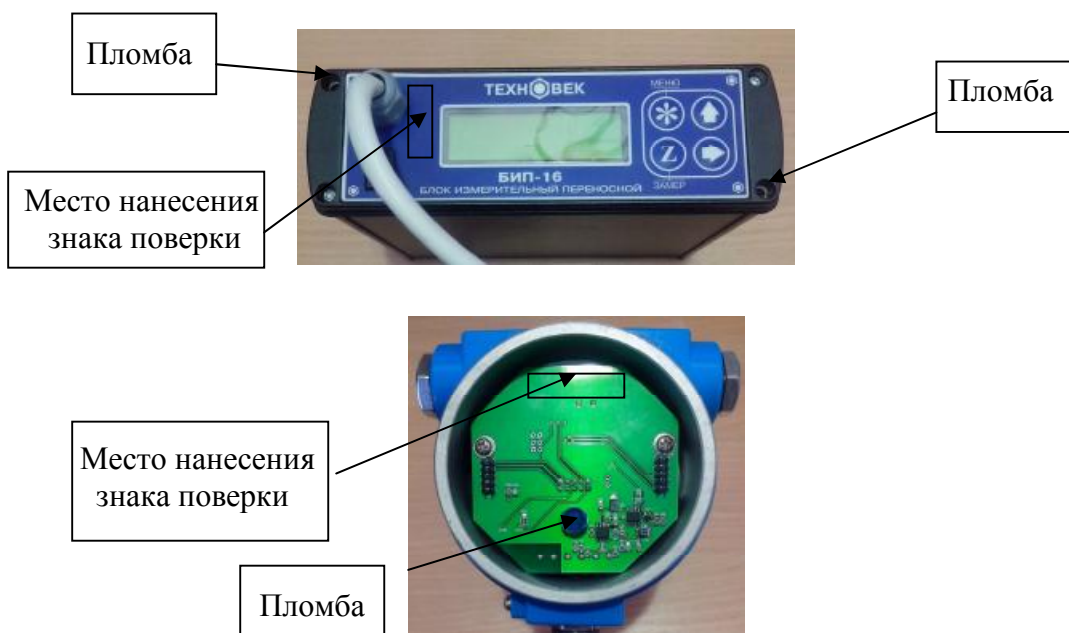
Рисунок 3 - Схема пломбирования БИП-16 и БЭ
