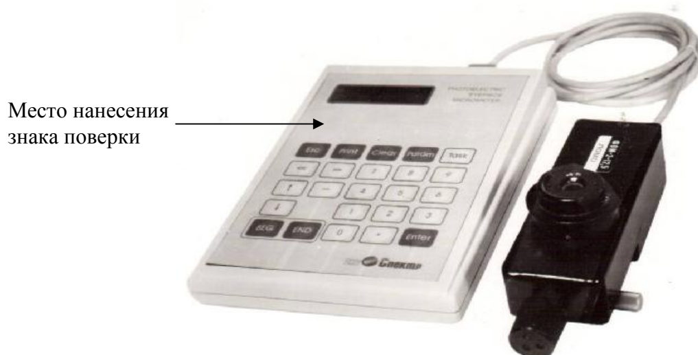
Рисунок 1 - Микрометры фотоэлектрические окулярные ФОМ-2
