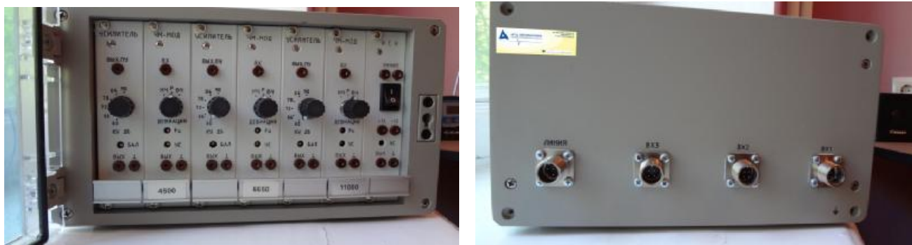
Рисунок 2 - Трехканальный подземный блок телеметрии АСПИ-М/Ш. (Вид спереди и сзади)
