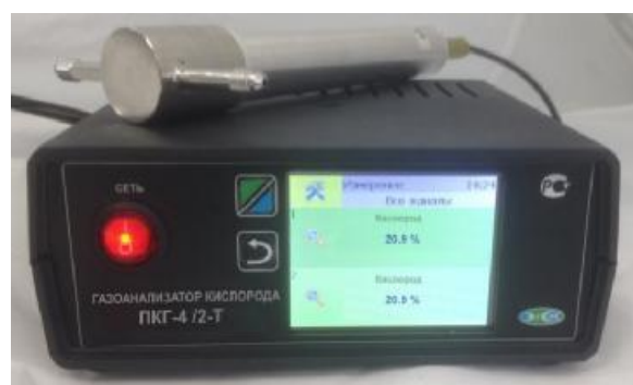
г) исполнение ПКГ-4/2-Т-К-4Р-2А (двухканальный, на фото показан только один измерительный преобразователь)
