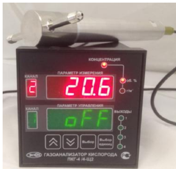
б) исполнение ПКГ-4/4-Щ2-К-4Р (четырёхканальный, на фото показан только один измерительный преобразователь)
