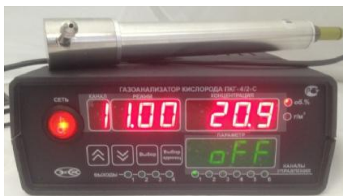
в) исполнение ПКГ-4/2-С-К-4Р-2А (двухканальный, на фото показан только один измерительный преобразователь)
