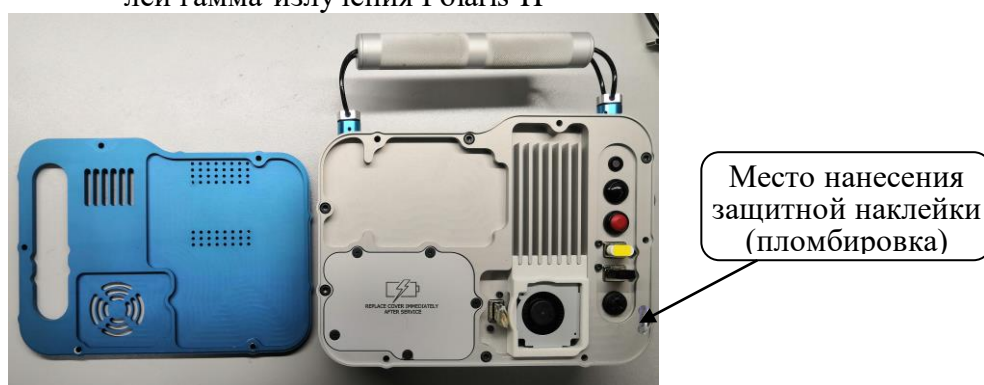
Рисунок 2 – Место нанесения защитной наклейки (пломбировка)
